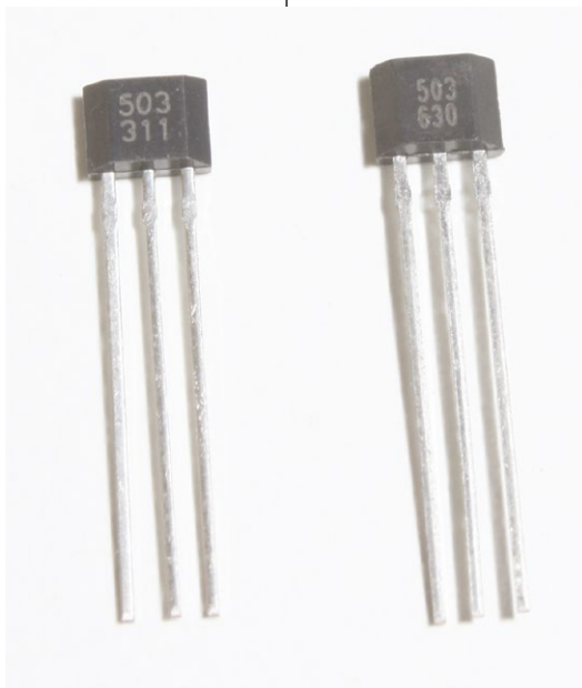
Fig. 6 : Capteurs à effet Hall. Il s'agit de modèles plutôt destinés à détecter le champ magnétique d'un aimant, mais ils peuvent également être mis en œuvre avec un tore de ferrite pour constituer un capteur très sûr, sans connexion électrique directe avec le courant à mesurer.
