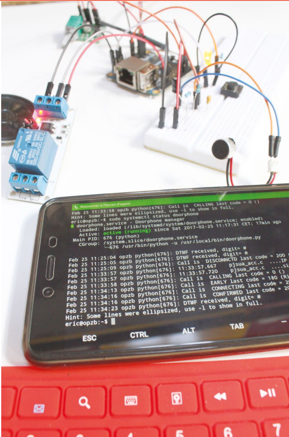
Fig. 3 : L'interphone à l'essai. Tous les composants d'un téléphone VoIP sont réunis ici, plus le relais qui vient d'être déclenché (led rouge allumée, et message de détection de la touche « # » dans les messages tracés).
