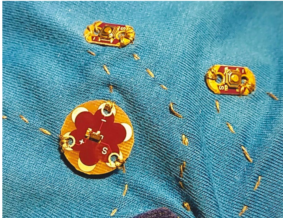
Figure 10 : Le « - » du capteur de température est relié au « - » du bouton de gauche (ça c'est bon). Mais ensuite, le « - » du bouton n'est relié à rien ! Il faut le relier à la masse. Ce qui est simple sur un breadboard devient beaucoup plus compliqué avec du fil cousu !
