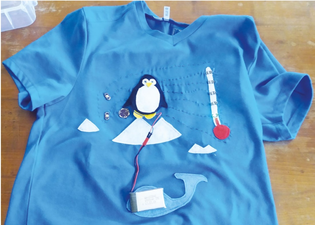
Figure 13 : Vue rapprochée de la réalisation finale. Le pingouin se trouve sur la banquise et cache l'Arduino. On peut néanmoins y accéder en soulevant ses pieds. La batterie supporte la batterie, et la température est affichée à droite par les LEDs. Le capteur de température et les boutons poussoirs pour le calibrage ne sont pas cachés et se trouvent à gauche.
