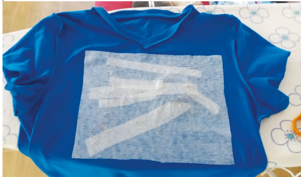
Figure 11 : Bandes thermocollantes, posées au fer à repasser au dos du T-shirt afin d'éviter des courts circuits accidentels lorsque le T-shirt se plisse et différents fils conducteurs se touchent. J'ai mis plusieurs bandes pour mieux isoler certains fils.
