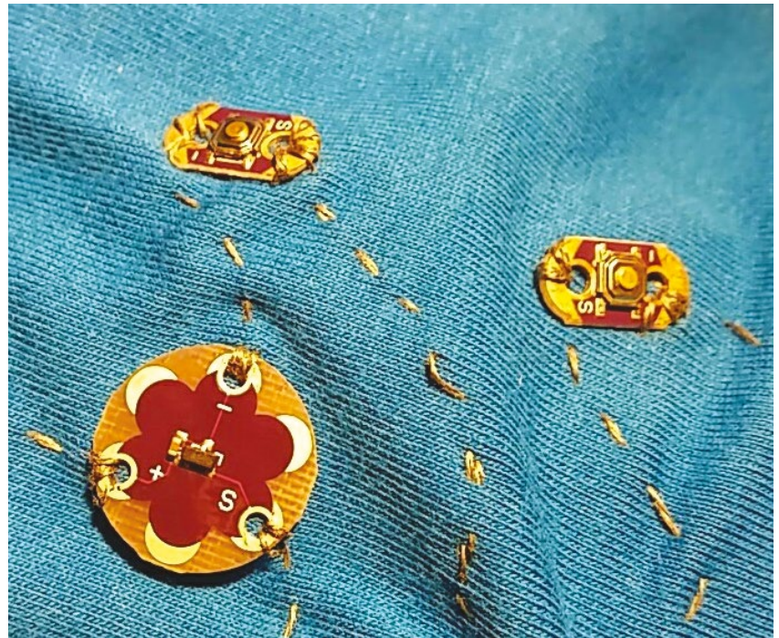
Figure 1 : Vue rapprochée du capteur de température Lilypad et de deux boutons Lilypad. Les composants sont cousus avec du fil conducteur.
