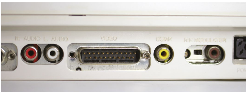
Un ordinateur comme cet Amiga 1200 propose une large gamme de sorties vidéos. De gauche à droite, après les sorties audios, on trouve ainsi le connecteur D-sub 23 proposant RGB, la sortie composite et celle du modulateur RF.
